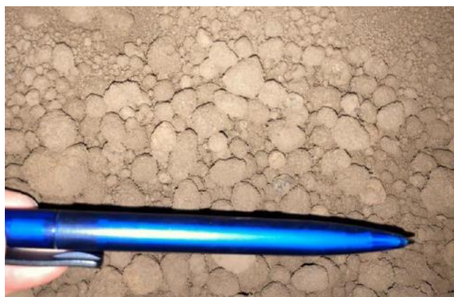
Figure 9 : Photographie du mélange BGL / poussières de four
